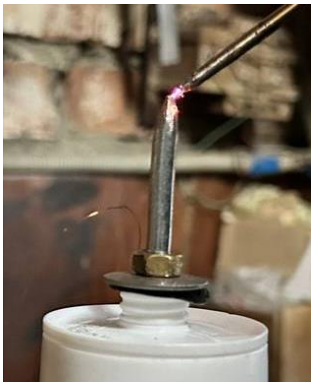
Разряд напряжения с оси катушки Тесла на острие шила
