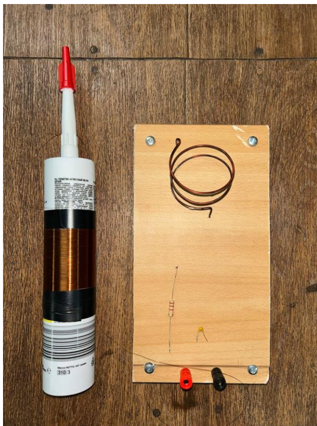
Самостоятельно изготовленные первичная и вторичная обмотки
